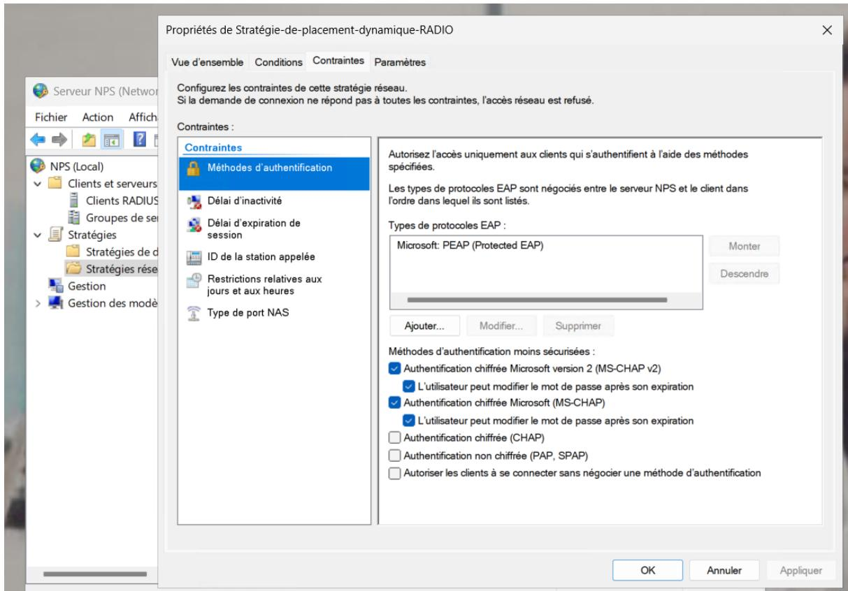
→ On accepte les Types de ports NAS Ethernet
